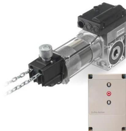
Centrale de commande 230 V - 50 Hz, IP55. Adaptée à tous les types de moteur, monophasé sans variateur intégré, d'une puissance maximale de 2,2 kW. Moteur avec débrayage à chaîne, fins de courses mécaniques, couple max 100 Nm. IP 54, 24 tr/min en sortie. Taille de la porte 30 m2. Poids de la porte 450 Kg. Câble longueur 7 m et chaîne 5 m.
