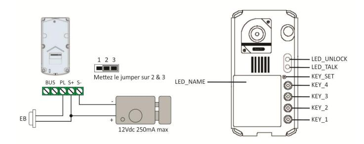
\* Avec le bouton poussoir EB (Exit Button), le temps de déverrouillage de la serrure n'est pas déterminé par le réglage du paramètre 'Unlock Time' sur le poste intérieur, mais la serrure est déverrouillée tant que le bouton-poussoir EB est enfoncé.
