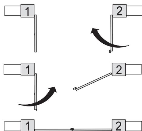
Donner une commande pas à pas. Le vantail [2] commence à se fermer. Dès qu'il atteint le point où l'on veut commencer à fermer le vantail [1], donner une nouvelle commande Pas à Pas. Les deux vantaux se ferment maintenant jusqu'à ce qu'ils atteignent leurs butées mécaniques respectives. Les deux LEDs rouges à gauche et à droite restent allumées en permanence.
