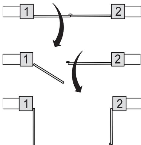
Donner une commande Pas à Pas. Le vantail [1] commence à s'ouvrir. Dès qu'il atteint le point où l'on veut commencer à ouvrir le vantail [2], donner une nouvelle commande Pas à Pas.
