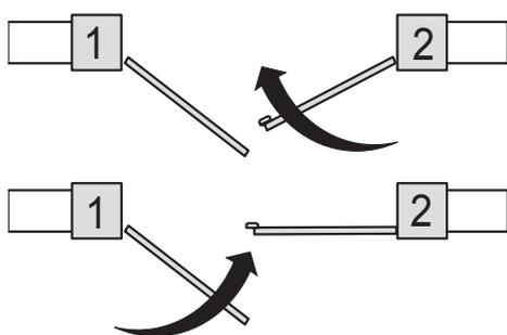
Pendant que les 5 LEDs clignotent, donner une commande Pas à Pas. Le vantail [2] doit se déplacer en fermeture. Une fois la butée mécanique atteinte, il doit s'arrêter et la LED de droite s'allume en rouge fixe.
