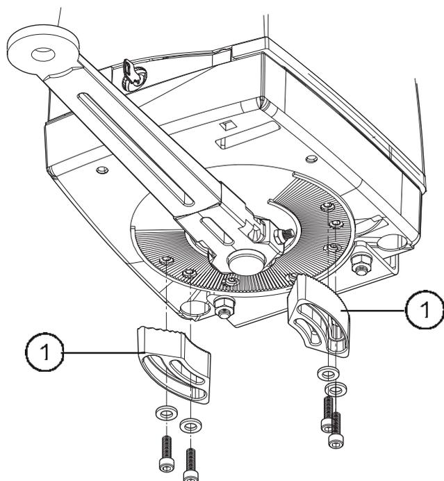
L'actionneur est équipé de deux fin de courses mécaniques qui ont la fonction de butées d'arrêt : elles doivent être fixées sur le côté inférieur de la base de l'opérateur.
