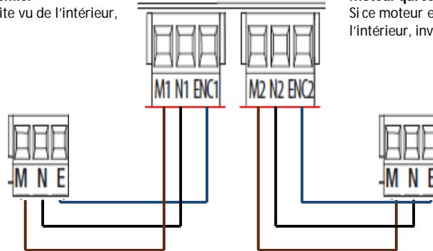
**ATTENTION :** Inverser les bornes M et N pour le motoréducteur installé à droite (vue intérieur)
