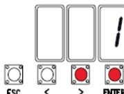
Sélectionner 1 et appuyer sur ENTER pour confirmer l'auto-apprentissage automatique de la course. Le moteur 1 puis le moteur 2 vont se fermer entièrement.
