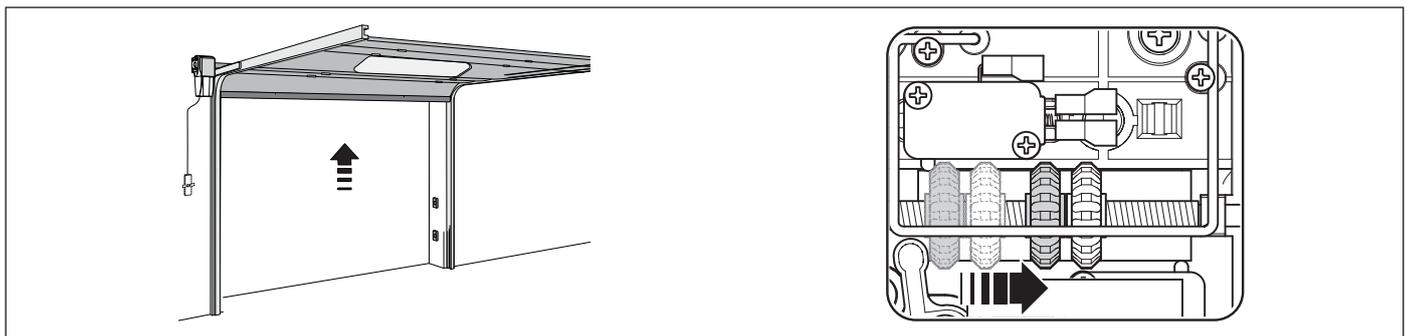
A l'aide d'un tournevis, soulevez l'agrafe du fin de course des couronnes dentées, tournez manuellement la couronne blanche jusqu'à ce qu'elle arrive au microinterrupteur d'ouverture et ensuite abaissez l'agrafe sur les couronnes.
