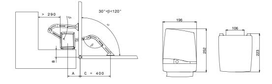
NB. Angolo ß da mantenere tra 30°/120° per avere uno sblocco ottimale, diversamente valutare utilizzo del braccio ARMAX
