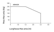
NB. Nelle zone ventose o con particolari forme strutturali del cancello si consiglia di ridurre i limiti di utilizzo e l'installazione di un'elettroserratura. Da valutare l'utilizzo del ARMAX, braccio snodato maggiorato con ante pannellate
